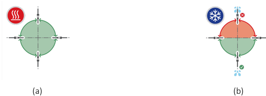
Abb. 6: Geeignete Einbauwinkel eines Temperaturfühlers in (a) einer Wärme- und (b) einer Kälteanlage.
